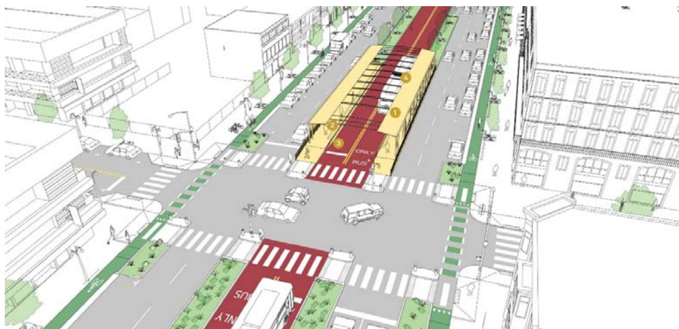
Fig. 3.26. Configurație cu benzi pentru transportul în comun dispuse în zona mediană și bandă de biciclete pentru fiecare sens
