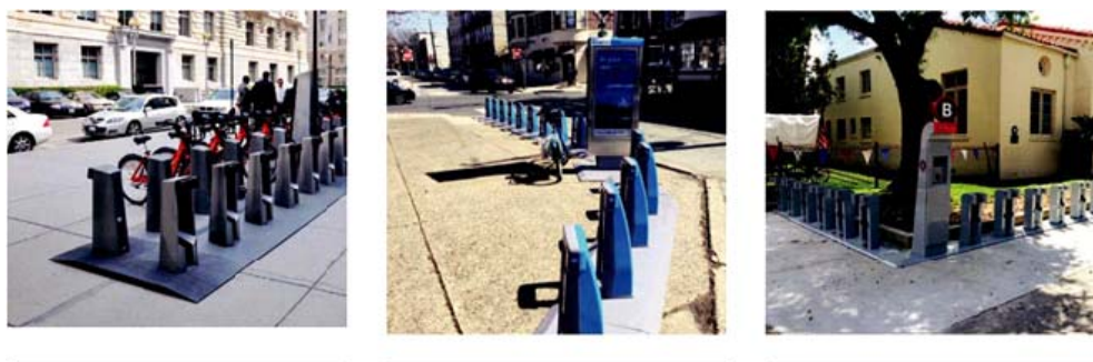
Fig. 3.14. Stație standard dublă, Stație în unghi, Stație în unghi drept ( Sursa: NACTO UBDG)
