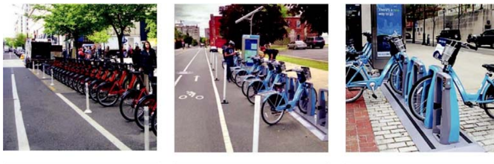
Fig. 3.10. Stație standard, Stație la 45 de grade, Stație dublă (cu două fețe) (Sursa: NACTO UBDG)
